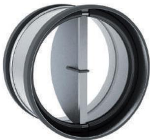
Les clapets anti-retour sont réalisés avec un corps en acier galvanisé embouti ( $\varnothing$  80 à 200 mm) ou soudé moleté ( $\varnothing$  200 à 400 mm).
