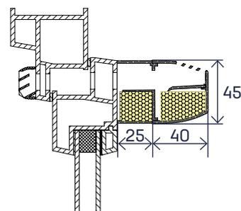
Le capuchon de façade **CE2A** est réalisé en matière plastique résistante aux UV blanc ou sur demande, dans la même couleur que les entrées d'air ISOLA.
