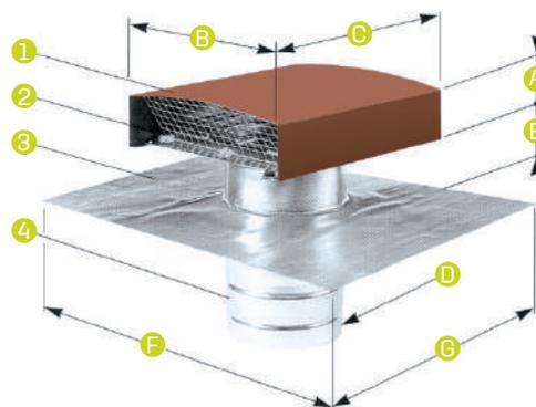
Le fourreau métallique ④ permettant le raccordement au conduit de ventilation est solidaire de la feuille de plomb ③ façonnable pour réaliser l'étanchéité.
