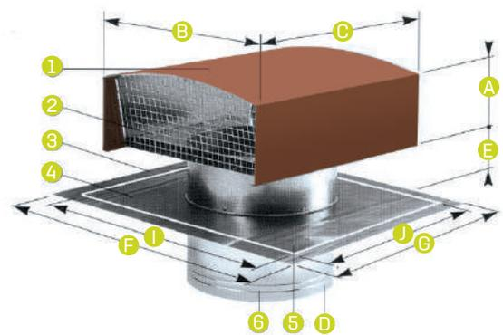
Le fourreau métallique ⑥ permettant le raccordement au conduit de ventilation est solidaire de la tôle support ④ se fixant sur la charpente, et de la feuille de plomb ③ façonnable pour réaliser l'étanchéité.
